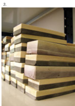
3. Na het ontginnen, splijten en polijsten wordt de scheersteen op een schistbalk gekleefd
